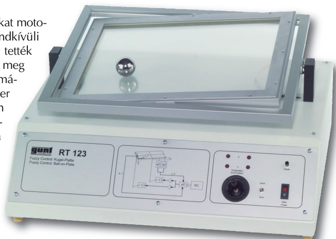
4. ábra. „Golyó a lapon” fuzzy-vezérlés modellezése
