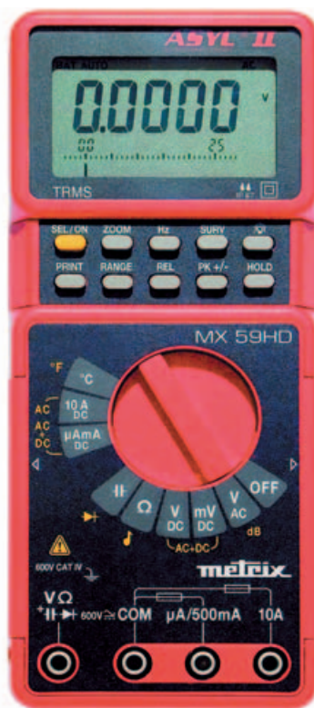
1. ábra. Nagy pontosságú ipari digitális multiméter előlapja – IP67-es védettség
