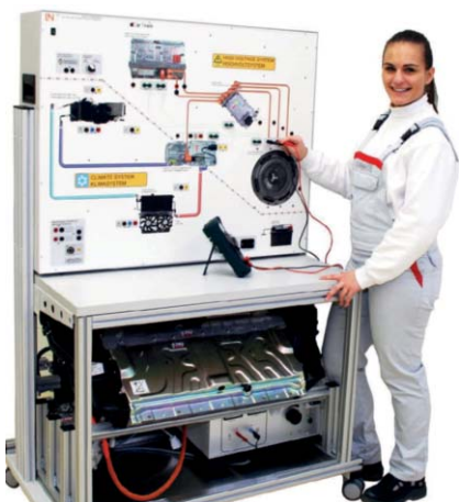
Nagyfeszültség és légkondicionálás – kombinált rendszer autóiipari oktatáshoz
